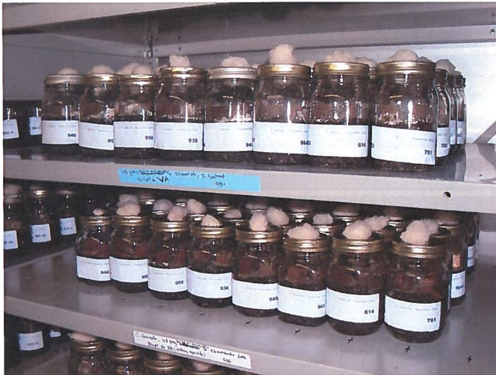
Figure 5 - Essais de dégradation fongique selon la norme AWPA E10
