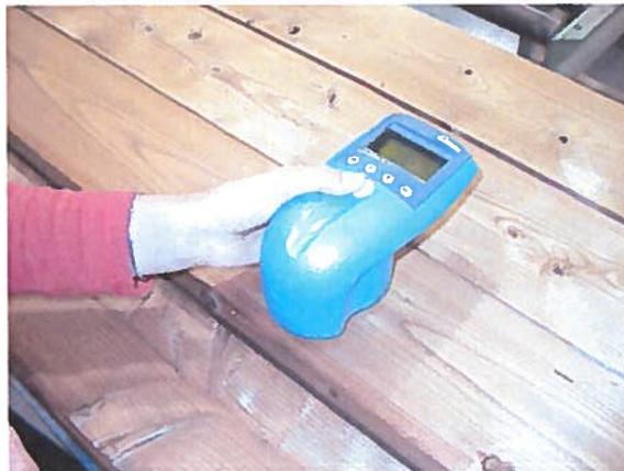
Figure 7 - Colorimètre BYK Gardner utilisé pour les mesures de couleur
