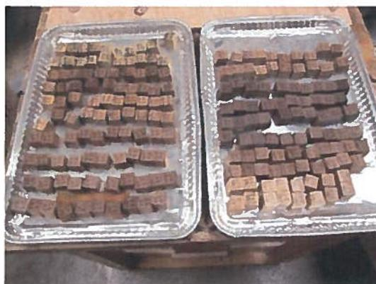
Figure 9 - Éprouvettes cubiques en cours de conditionnement à 20°C – 65% HR
