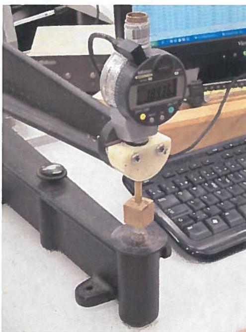
Figure 8 - Mesure des dimensions d'un cube
