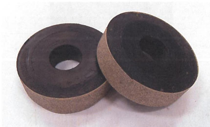
Figure 11 - Roulettes de caoutchouc CS-0 avec bandes abrasives S-42 assemblées
