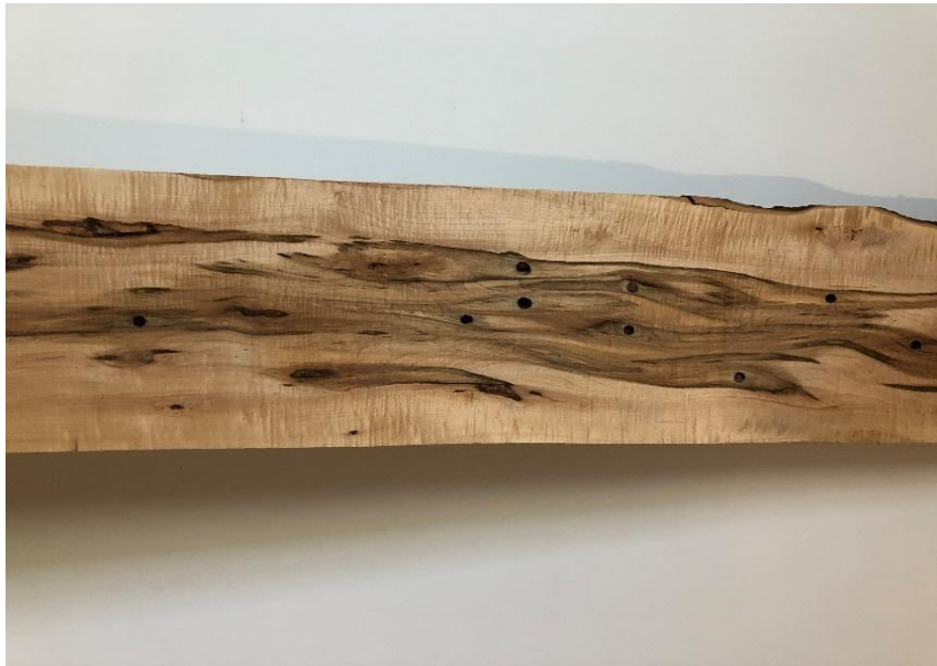
Planche (pièce de bois scié) provenant d'une bille de pied d'un érable ayant été entaillé à de multiples reprises.
