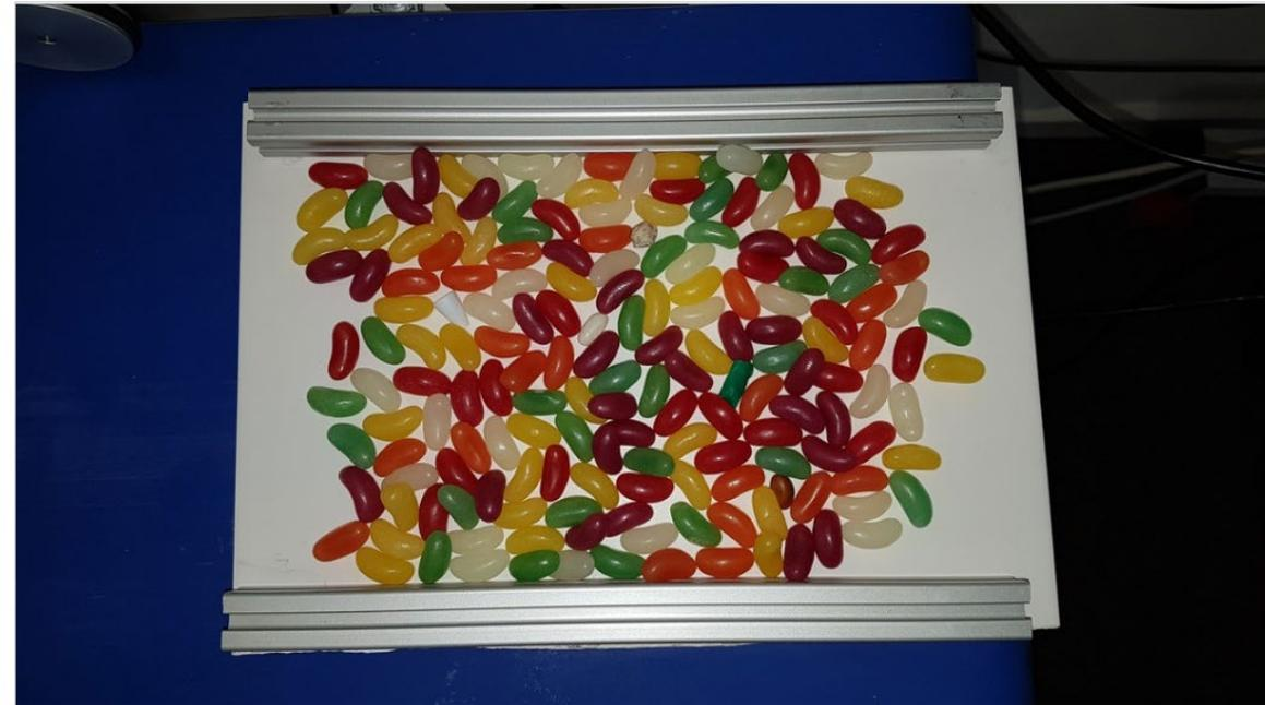
Les « jelly beans » et les corps étrangers non métalliques : les couleurs et les formes sont différentes ; la densité est similaire. Difficile de les distinguer avec un système conventionnel.
