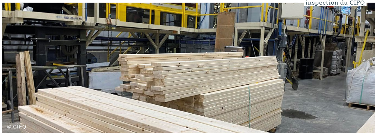
Pièces déclassées mises de côté lors d'une inspection du CIFQ
