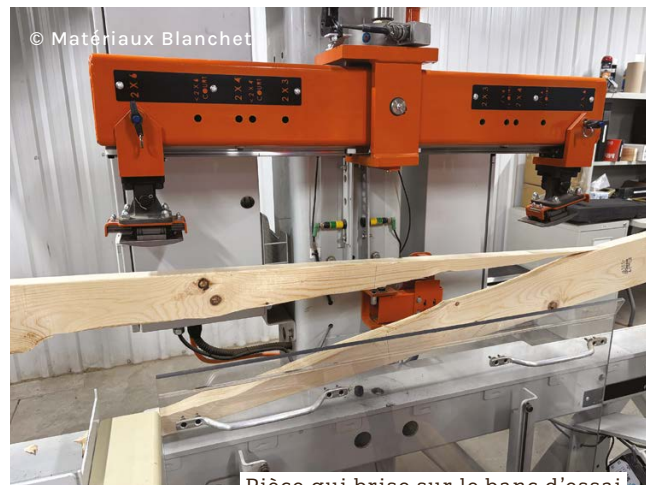
Pièce qui brise sur le banc d'essai (MOE de la pièce trop faible).
